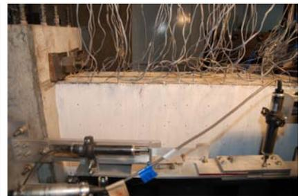
継手不良を有するRC部材に関する実験
